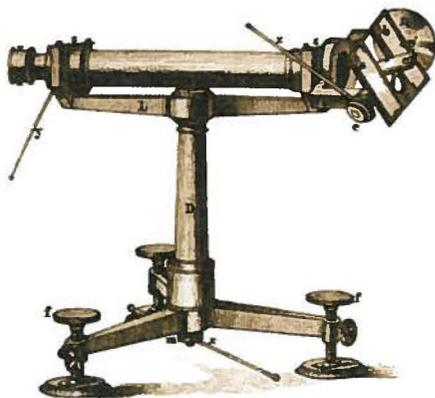
El heliotropo fue uno de los instrumentos creados por Gauss, de gran ayuda en los estudios geodésicos. Este aparato, que dispone de un espejo móvil, refleja la luz del Sol en una dirección predeterminada, haciendo posible la alineación de los instrumentos topográficos.
